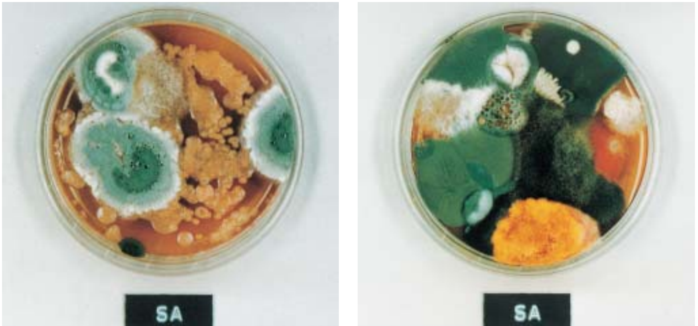
Abb. 1 und 2: Mikrobiologische Abstriche ungenügend entwässerter Dieselproben
