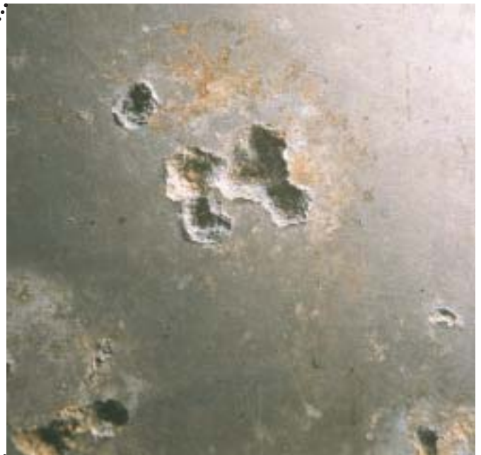
Abb. 4 und 5: Oberflächenzerstörung im Dieselöltank eines Schiffes
